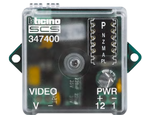
347400 Interface caméra coaxiale - BUS 2 fils vidéo
