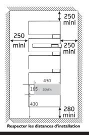
Respectez les distances minimales avec le mobilier pour l'emplacement de l'appareil.
