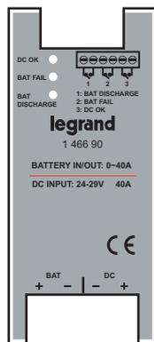
DC OK allumé (vert) = module en service →  $21V < U_{DC} \leq 29V$  - contact 3 fermé
